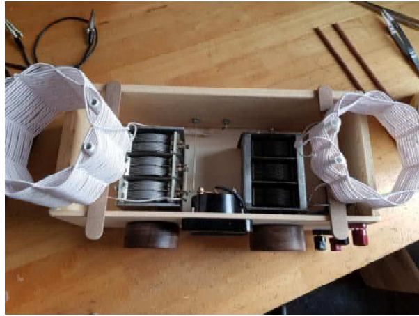
vista dei due condensatori
