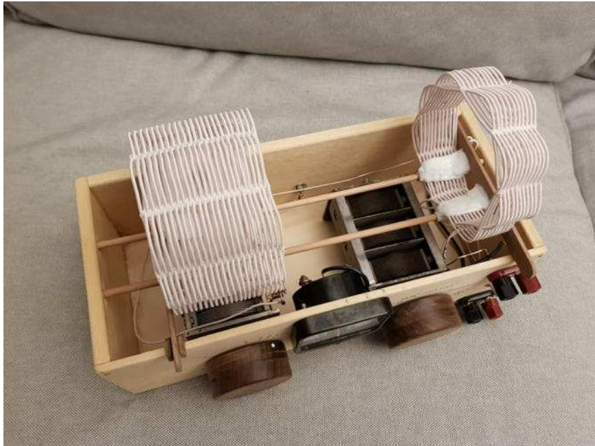
Si notano i due pioli sulla bobina attaccati con la colla a caldo, gli altri dopo aver cucito le spire le ho tolte.
