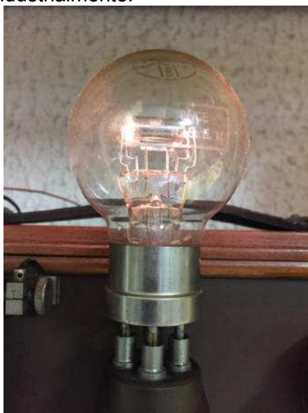
Triodo Audion acceso, notare la forte luminescenza del doppio filamento
