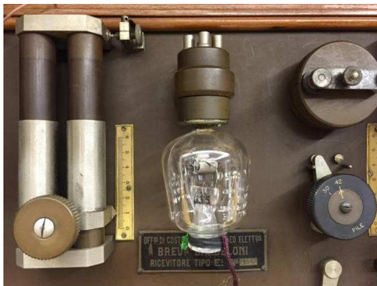
Triodo tipo Audion, in tempo di guerra la valvola impiegata veniva chiamata "Gorizia".
