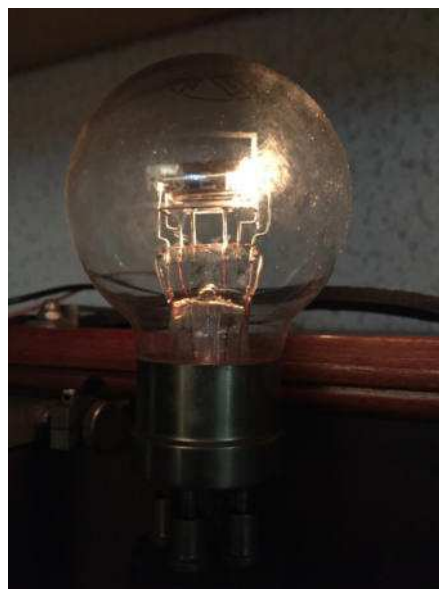
Triodo Audion acceso, notare la forte luminescenza del doppio filamento
