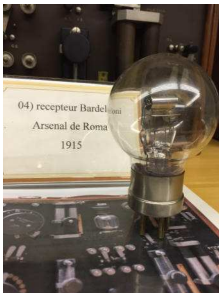
Triodo tipo Audion, in tempo di guerra la valvola impiegata veniva chiamata "Gorizia".
